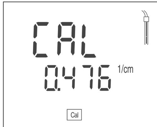
4. Messzelle in die Kontrollstandardlösung (0,01 mol/l KCl) tauchen.
