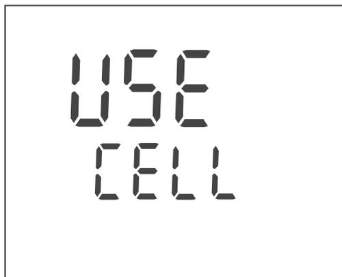
3. Mit **<ENTER>** oder **<CAL\_\_>** die Auswahl (*Use Cell*) bestätigen. Die zuletzt eingestellte Zellenkonstante wird angezeigt.
