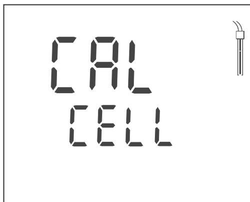
3. Mit **<ENTER>** oder **<CAL\_\_>** die Auswahl (*Cal Cell*) bestätigen. Die Zellenkonstante der letzten Kalibrierung wird angezeigt.
