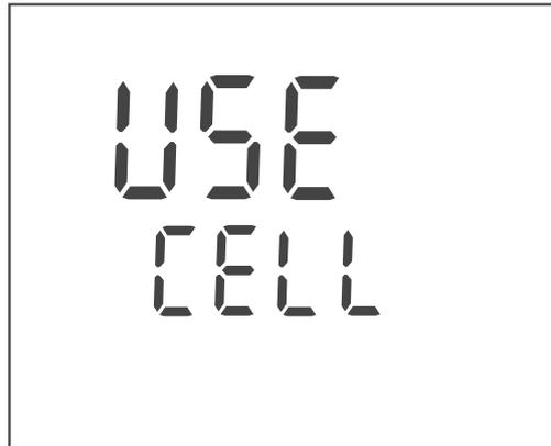
3. Mit **<ENTER>** oder **<CAL\_\_>** die Auswahl (*Use Cell*) bestätigen. Die Zellenkonstante der letzten Kalibrierung wird angezeigt.
